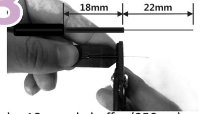
Pelar 18 mm de buffer (250um) y 22 mm de cladding (125 um)
