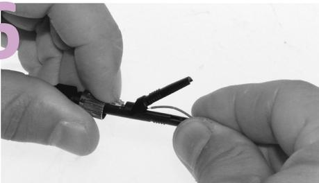
Mantener el cable flexionado y simultaneamente deslizar la pestaña del conector hacia atrás. Es muy importante mantener el cable flexionado mientras se desliza la pestaña.
