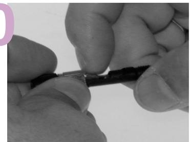
Deslizar la pestaña hacia delante para poder extraer la fibra.
