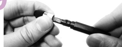
Desmontar el conector desenroscando el tapón.
