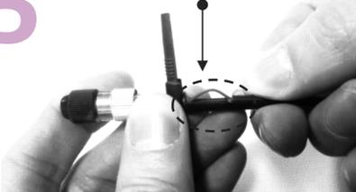
Insertar la fibra con cuidado evitando rozar la punta e insertar por el orificio hasta que la fibra se flexione.
