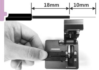
Limpiar la fibra con toallita impregnada ligeramente de alcohol isopropílico, posteriormente cortar la fibra dejando 10mm de cladding.
