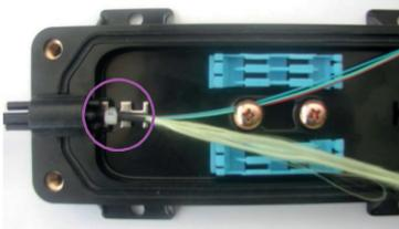
Sujete el cable de fibra a la abrazadera metálica mediante una brida de plástico.
