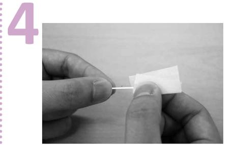
Limpie la fibra con una toallita impregnada ligeramente en alcohol isopropílico.
