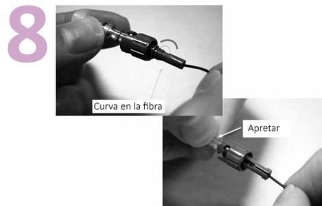
Antes de roscar la bota del conector cortar las aramidas dejando +1cm que se roscarán sobre la bota para aportar tracción a la conexión.
