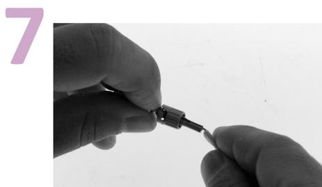
Mantener el cable flexionado y simultáneamente presionar ligeramente el bloqueo del conector hasta escuchar un "click"
