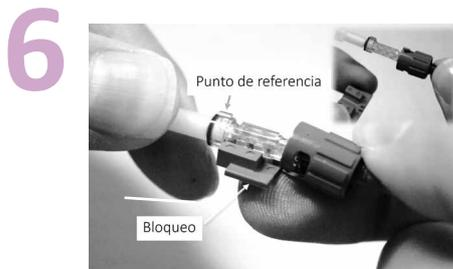
Retirar el bloqueo e insertar la fibra con cuidado hasta que la fibra quede flexionada.
