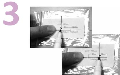
Utilice la etiqueta del conector para pelar buffer(250um) a 15mm y el cladding (125um) a 10mm. La longitud del cladding inicialmente deberá de ser de 22mm.
