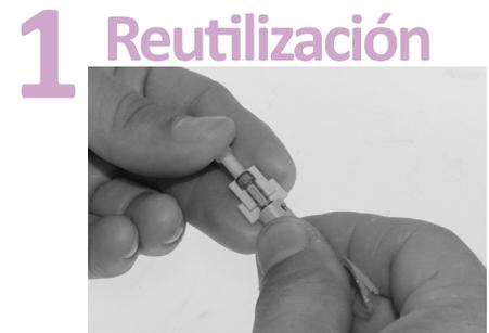
Desenroscar la bota y volver a colocar la base para liberar la fibra y poder volver a iniciar el proceso.
