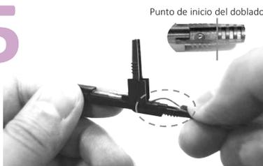
Introducir la fibra con cuidado evitando rozar la punta e insertar hasta que la fibra flexione.
