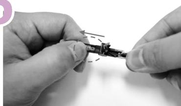
Mantener el cable flexionado y simultaneamente deslizar la pestaña del conector hacia adelante. Es muy importante mantener el cable flexionado mientras se desliza la pestaña.
