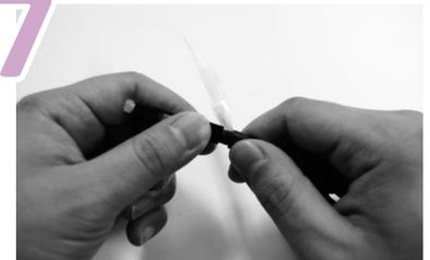
Antes de roscar la bota del conector cortar las aramidas dejando +-1cm, que se roscarán sobre la bota para aportar tracción a la conexión.
