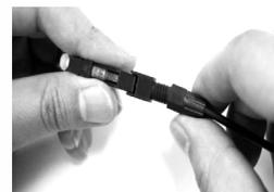
Para extraer la carcasa presionar ligeramente ésta hacia abajo apoyando el conector sobre una superficie lisa y posteriormente desenroscar la bota.
